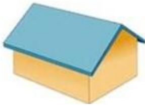
Techo a dos aguas
